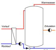
Für die Trinkwasseraufbereitung in Speichern sind aus hygienischen (SVGW, 2020, S. 18) und technischen Gründen, insbesondere zur Einhaltung der Rücklauftemperatur (siehe 3.2.1), aussenliegende Wärmeübertrager (Schichtladung) innenliegenden Wärmeübertragern (Stufenladung) vorzuziehen.
